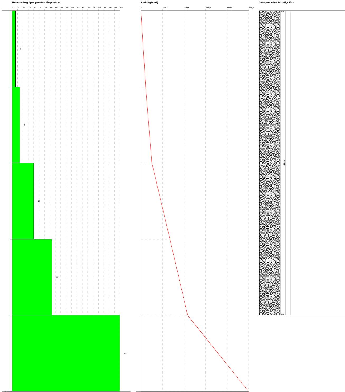
**ENSAYO PENETROMÉTRICO DINÁMICO P4**
